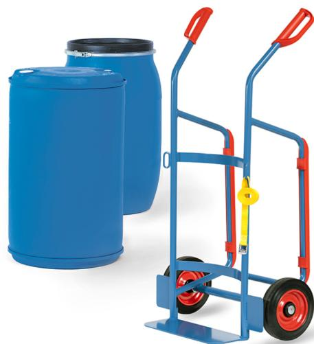
Ensemble mécano-soudé, revêtement époxy bleu RAL 5007. Diable compatible pour fûts en plastique de 120-220 litres. Sangle sécurisant la charge. Roues à bandage caoutchouc, moyeu à roulement à rouleaux. Hauteur: 1300 mm; Largeur: 640 mm.
