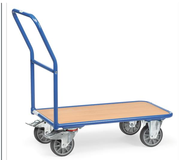
Ensemble mécano-soudé, revêtement époxy bleu RAL 5007 uniquement. Plateforme en mélaminé surface effet hêtre, 2 roues pivotantes et 2 roues fixes à bandage TPE, moyeu à roulement à billes central. Freins sur roues pivotantes.
