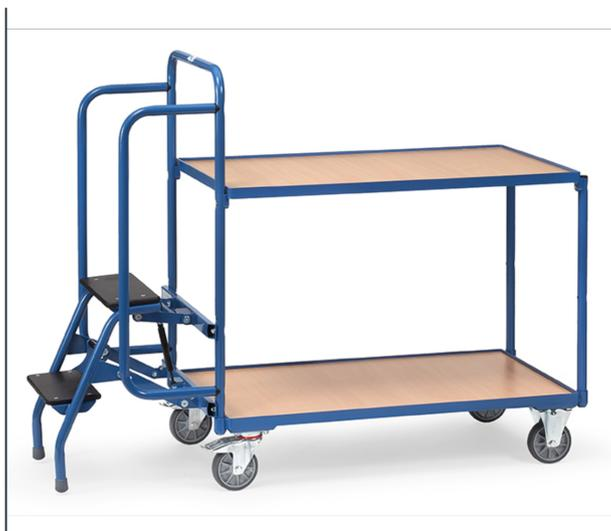
Ensemble mécano-soudé, revêtement époxy bleu RAL 5007. 2 plateaux fixes en mélaminé surface effet hêtre posés dans des cornières de 12 mm de haut. Marchepied se soulevant quand les marches sont libres et s'appuyant sur le sol par le poids de l'utilisateur. Le chariot est automatiquement bloqué. Hauteur escabeau: 515 mm. 2 roues pivotantes et 2 roues fixes à bandage TPE, moyeu à roulement à billes central. Freins sur roues pivotantes. Charge maximum étagère haute: 80 kg.
