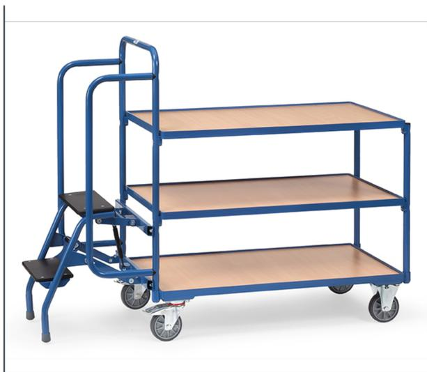
Ensemble mécano-soudé, revêtement époxy bleu RAL 5007. 3 plateaux fixes en mélaminé surface effet hêtre posés dans des cornières de 12 mm de haut. Marchepied se soulevant quand les marches sont libres et s'appuyant sur le sol par le poids de l'utilisateur. Le chariot est automatiquement bloqué. Hauteur escabeau: 515 mm. 2 roues pivotantes et 2 roues fixes à bandage TPE, moyeu à roulement à billes central. Freins sur roues pivotantes. Charge maximum étagère haute: 80 kg.
