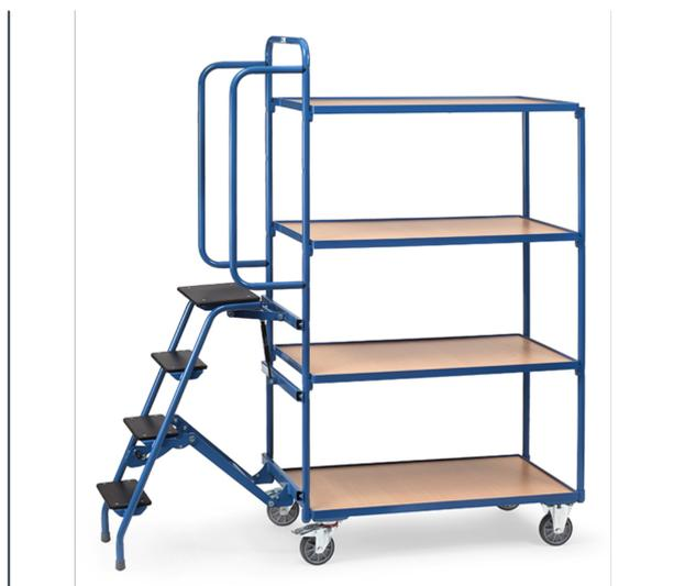
Ensemble mécano-soudé, revêtement époxy bleu RAL 5007. 4 plateaux fixes en mélaminé surface effet hêtre posés dans des cornières de 12 mm de haut. Marchepied se soulevant quand les marches sont libres et s'appuyant sur le sol par le poids de l'utilisateur. Le chariot est automatiquement bloqué. Hauteur escabeau: 935 mm. 2 roues pivotantes et 2 roues fixes à bandage TPE, moyeu à roulement à billes central. Freins sur roues pivotantes. Charge maximum étagère haute et médianes: 80 kg.
