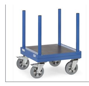
Ensemble mécano-soudé, avec barres en tube d'acier, revêtement époxy bleu RAL 5007. Plateau en contreplaqué plastifié hydrofuge et antidérapant. 4 roues pivotantes pour charges lourdes à bandage caoutchouc élastique, moyeu à roulement à billes. 2 roues pivotantes avec freins. Largeur libre entre les barres 510 mm.
