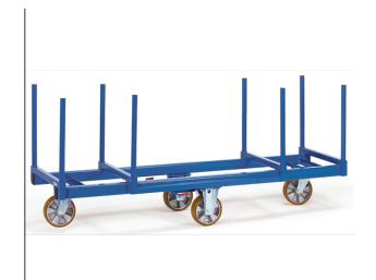
Ensemble mécano-soudé, avec barres en tube d'acier, revêtement époxy bleu RAL 5007. Armature ouverte, compatible pour pont et fourches de chariot. Roues en losange à bandage polyuréthane 200 x 50 mm, moyeu à roulement à billes. Freins sur roues du milieu. Largeur totale: 600 mm, largeur utile: 500 mm.
