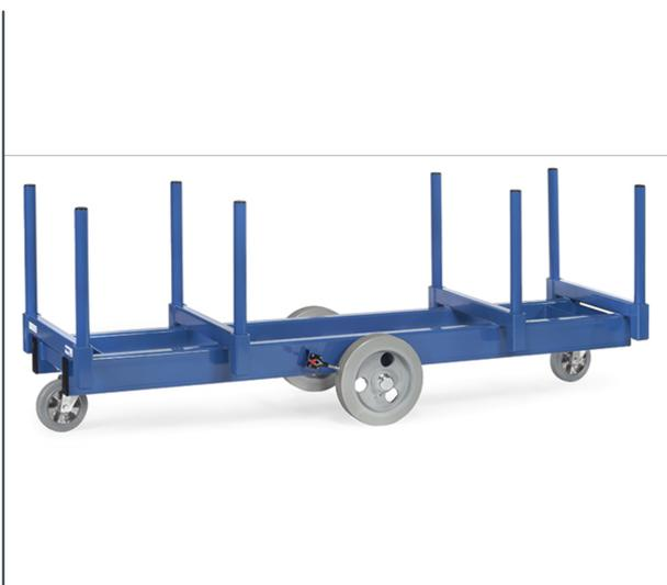
Ensemble mécano-soudé, avec barres en tube d'acier, revêtement époxy bleu RAL 5007. Armature ouverte, compatible pour pont et fourches de chariot. Roues en losange à bandage caoutchouc élastique, au milieu 360 x 75 mm, au bout 200 x 50 mm, moyeu à roulement à billes. Freins sur roues du milieu.
