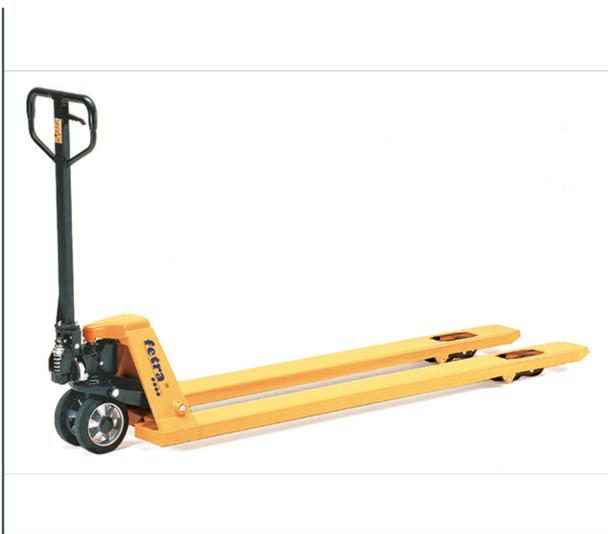
Châssis et fourches en tôle d'acier, revêtement époxy jaune. Pompe hydraulique manuelle, sans entretien. Poignée habillée de caoutchouc pour: lever - rouler - descendre. Modèles rallongés, longueur fourches 1500 mm. Roues directrices à bandage caoutchouc Ø 200 x 50 mm, boggie en nylon Ø 80 x 70 mm. Charge réduite.
