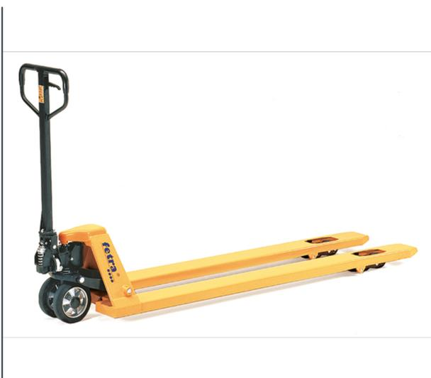
Châssis et fourches en tôle d'acier, revêtement époxy jaune. Pompe hydraulique manuelle, sans entretien. Poignée habillée de caoutchouc pour: lever - rouler - descendre. Modèles rallongés, longueur fourches 1800 mm. Roues directrices à bandage caoutchouc Ø 200 x 50 mm, boggie en nylon Ø 80 x 70 mm. Charge réduite..
