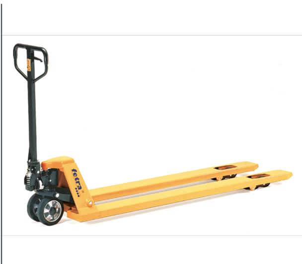
Châssis et fourches en tôle d'acier, revêtement époxy jaune. Pompe hydraulique manuelle, sans entretien. Poignée habillée de caoutchouc pour: lever - rouler - descendre. Modèles rallongés, longueur fourches 2000 mm. Roues directrices à bandage caoutchouc Ø 200 x 50 mm, boggie en nylon Ø 80 x 70 mm. Charge réduite.
