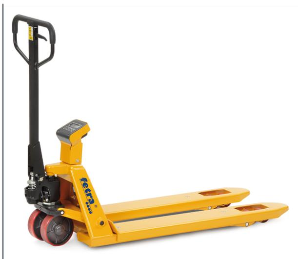
Châssis et fourches en tôle d'acier, revêtement époxy jaune. Pompe hydraulique manuelle, sans entretien. Poignée habillée de caoutchouc pour: lever - rouler - descendre. Système de pesée de 1 à 2000 kg, graduation par kg. Ecart mesure +/- 0,1 %. Affichage LCD avec chiffres de 18 mm. Touche d'allumage et de mise à zéro. Alimentation par 4 piles de 1,5 V-AA. Roues directrices en polyuréthane Ø 180 x 50 mm, galet de fourches en polyuréthane tandem Ø 70 x 70 mm. Largeur de portée 550 mm.
