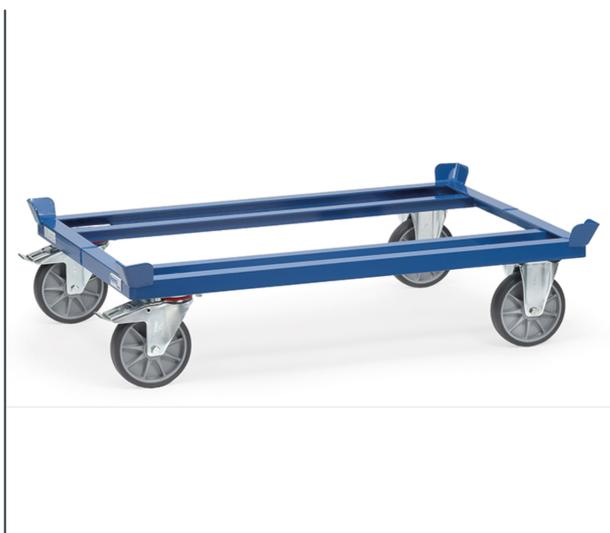
Construction en profilé d'acier mécano-soudé, revêtement époxy bleu RAL 5007, avec 4 inserts support de palettes. Pour palettes bois ou grillagées. 2 roues fixes et 2 roues pivotantes à bandage TPE, moyeu à roulement à billes. Freins sur roues pivotantes. Déplacement peu bruyant sur sols plats, bandage non traçant.
