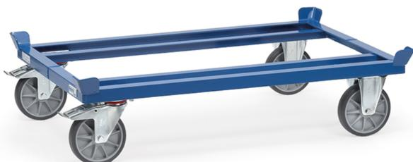
Construction en profilé d'acier mécano-soudé, revêtement époxy bleu RAL 5007, avec 4 inserts support de palettes. Pour palettes bois ou grillagées. 2 roues fixes et 2 roues pivotantes à bandage TPE, moyeu à roulement à billes. Freins sur roues pivotantes. Déplacement peu bruyant sur sols plats, bandage non traçant.
