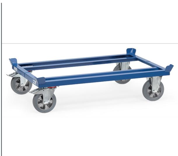
Construction en profilé d'acier mécano-soudé, revêtement époxy bleu RAL 5007, avec 4 inserts support de palettes. Pour palettes bois ou grillagées. 2 roues fixes et 2 roues pivotantes à bandage caoutchouc élastique confort, bleu-gris non traçant, moyeu à roulement à billes. Freins sur roues pivotantes. Peu de résistance au déplacement. Roulement élastique, sans bruit.
