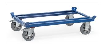
Construction en profilé d'acier mécano-soudé, revêtement époxy bleu RAL 5007, avec 4 inserts support de palettes. Pour palettes bois ou grillagées. 2 roues fixes et 2 roues pivotantes à bandage caoutchouc élastique confort, bleu-gris non traçant, moyeu à roulement à billes. Freins sur roues pivotantes. Peu de résistance au déplacement. Roulement élastique, sans bruit.
