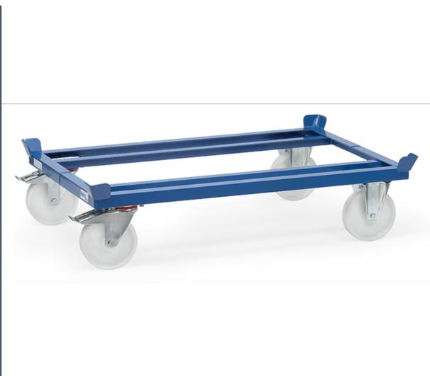
Construction en profilé d'acier mécano-soudé, revêtement époxy bleu RAL 5007, avec 4 inserts support de palettes. Pour palettes bois ou grillagées. 2 roues fixes et 2 roues pivotantes en polyamide, moyeu à roulement à rouleaux. Freins sur roues pivotantes. Roulement aisé et non traçant mais bruyant. Roues résistantes aux agents corrosifs.
