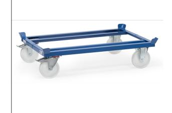
Construction en profilé d'acier mécano-soudé, revêtement époxy bleu RAL 5007, avec 4 inserts support de palettes. Pour palettes bois ou grillagées. 2 roues fixes et 2 roues pivotantes en polyamide, moyeu à roulement à rouleaux. Freins sur roues pivotantes. Roulement aisé et non traçant mais bruyant. Roues résistantes aux agents corrosifs.
