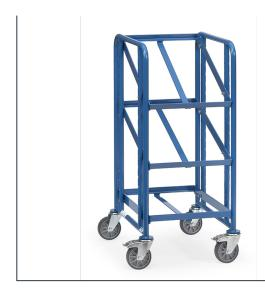
Ensemble mécano-soudé, revêtement époxy bleu RAL 5007. 3 plateaux amovibles en profilé avec armature ouverte pour 1 bac plastique 600 x 400 mm. Plateaux réglables au pas de 50 mm et inclinables de 15° et 30°. 4 roues pivotantes à bandage TPE, moyeu à roulement à billes. 2 roues avec freins. Charge plateau haut et intermédiaire: 80 kg. Livré sans bacs.
