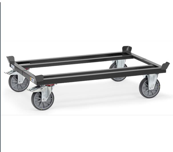
Pour palettes en bois et grillagées, construction renforcée en profilé soudé, avec 4 coins de centrage, revêtement époxy gris RAL 7015, 2 roues pivotantes et 2 fixes, Bandage TPE-ESD, moyeu à roulement à billes, freins sur roues pivotantes. Peu de résistance au démarrage et à la rotation, déplacement silencieux sur sols plats. Roues non traçantes.
