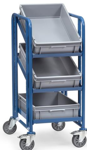
Ensemble mécano-soudé, revêtement époxy bleu RAL 5007. 3 plateaux amovibles, armature ouverte avec 3 bacs plastiques 600 x 400 x 145 mm. Plateaux réglables au pas de 50 mm et inclinables de 15° et 30°. 4 roues pivotantes à bandage TPE, moyeu à roulement à billes. 2 roues avec freins. Charge plateau du haut et intermédiaire: 80 kg.
