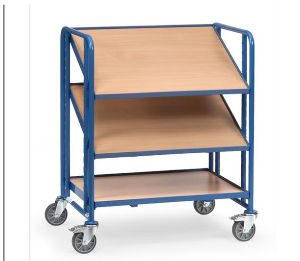
Ensemble mécano-soudé, revêtement époxy bleu RAL 5007. 3 plateaux amovibles avec mélaminé surface effet hêtre avec rebord de 13 mm. Plateaux réglables au pas de 50 mm et inclinables de 15° et 30°. 4 roues pivotantes à bandage TPE, moyeu à roulement à billes. 2 roues avec freins. Charge plateau haut et intermédiaire: 80 kg. Livré sans bacs
