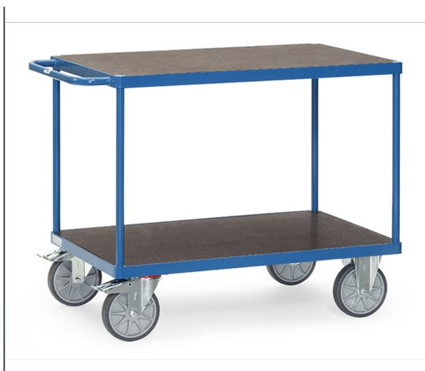
Système modulaire. Ensemble mécano-soudé, revêtement époxy bleu RAL 5007. Dimensions utiles 1000 x 700 mm. Avec 2 plateaux en contreplaqué antidérapant hydrofuge. Charge plateau du haut, maxi 200 kg. 2 roues pivotantes et 2 roues fixes à bandage TPE, moyeu à roulement à billes central. Freins sur roues pivotantes.
