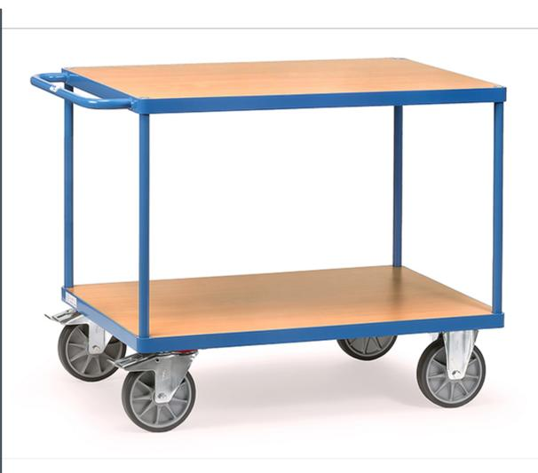
Ensemble mécano-soudé, revêtement époxy bleu RAL 5007 avec 2 plateaux en mélaminé surface effet hêtre. Charge maximum plateau du haut: 200 kg. 2 roues pivotantes et 2 roues fixes à bandage TPE, moyeu à roulement à billes central. Freins sur roues pivotantes.
