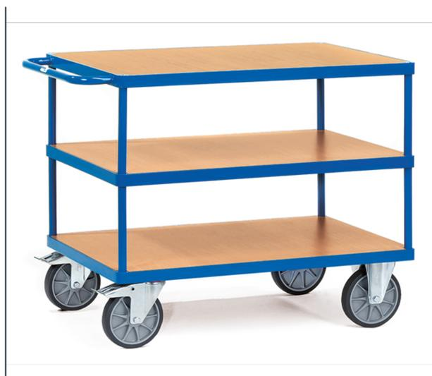
Ensemble mécano-soudé, revêtement époxy bleu RAL 5007 avec 3 plateaux en mélaminé surface effet hêtre. Charge maximum plateau du haut: 200 kg. 2 roues pivotantes et 2 roues fixes à bandage TPE, moyeu à roulement à billes central. Freins sur roues pivotantes.
