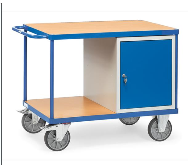
Construction en profilé et tube d'acier, revêtement époxy, caisson gris RAL 7035, armature et porte RAL 5007. Plateaux en bois. Charge plateau du haut: 200 kg. 1 placard verrouillable en tôle d'acier (HXLXP: 600 x 500 x 700 mm) avec porte, 1 étagère fixe et 2 amovibles, charge par étagère placard: 30 kg. 2 roues pivotantes et 2 roues fixes à bandage TPE, moyeu à roulement à billes central. Freins sur roues pivotantes.
