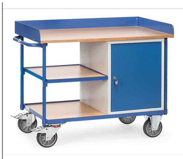
Construction en profilé et tube d'acier, revêtement époxy, caisson gris RAL 7035, armature et porte RAL 5007, plan de travail en contreplaqué de 22 mm avec rebord sur 3 côtés de 80 mm de haut, 1 placard verrouillable en tôle d'acier (HXLXP: 600 X 500 X 600 mm) avec 2 plateaux amovibles. Charge par plateau 30 kg. 2 roues pivotantes et 2 roues fixes à bandage TPE, moyeu à roulement à billes central. Freins sur roues pivotantes.
