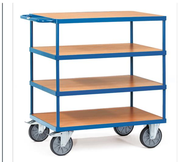
Ensemble mécano-soudé, revêtement époxy bleu RAL 5007 avec 4 plateaux en mélaminé surface effet hêtre. Charge maximum plateau du haut: 200 kg. 2 roues pivotantes et 2 roues fixes à bandage TPE, moyeu à roulement à billes central. Freins sur roues pivotantes.
