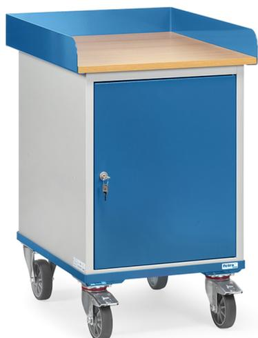
Placard roulant acier avec porte verrouillable. 1 plateau fixe et 2 amovibles. Plan de travail en mélaminé renforcé épaisseur 19 mm avec rebord sur 3 côtés de 80 mm. Revêtement époxy, caisson gris RAL 7035, armature et ouvertures RAL 5007. 2 roues pivotantes et 2 roues fixes à bandage TPE, moyeu à roulement à billes central. Freins sur roues pivotantes. Charge maximum par étagère: 30 kg.
