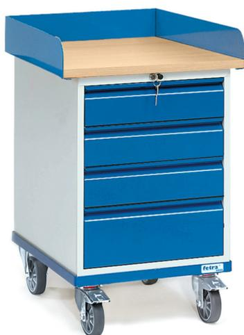
Placard roulant acier à tiroirs, verrouillage central, sur glissière à billes. Plan de travail en mélaminé renforcé épaisseur 19 mm, avec rebord sur 3 côtés de 80 mm, 3 tiroirs de 120 mm et 1 de 180 mm sur glissière. Revêtement époxy, caisson gris RAL 7035, armature et ouvertures RAL 5007. 2 roues pivotantes et 2 roues fixes, moyeu à roulement à billes central. Freins sur roues pivotantes. Charge maximum par tiroir: 25 kg.
