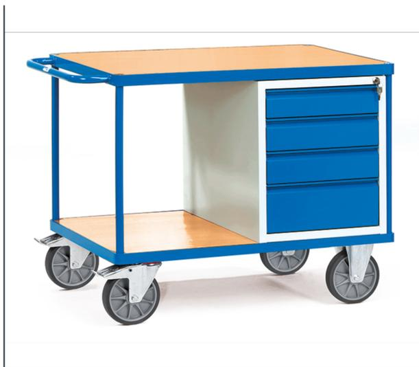
Construction en profilé et tube d'acier, revêtement époxy, caisson gris RAL 7035, armature et tiroirs RAL 5007. Plateaux en bois, 1 placard à tiroirs à serrure centrale (HXLXP: 600 x 500 x 700 mm) avec 4 tiroirs (1 X 105 mm, 2 x 120 mm et 1 x 180 mm). Charge par tiroir: 25 kg. 2 roues pivotantes et 2 roues fixes à bandage TPE, moyeu à roulement à billes central. Freins sur roues pivotantes.
