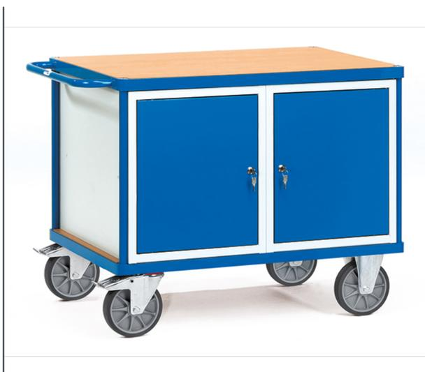
Construction en profilé et tube d'acier, revêtement époxy, caisson gris RAL 7035, armature et portes RAL 5007. Plateaux en bois, 2 placards verrouillables (HXLXP: 600 x 500 x 700 mm) avec portes et 1 étagère fixe et 2 amovibles. Charge par étagère placard: 30 kg. 2 roues pivotantes et 2 roues fixes à bandage TPE, moyeu à roulement à billes central. Freins sur roues pivotantes.
