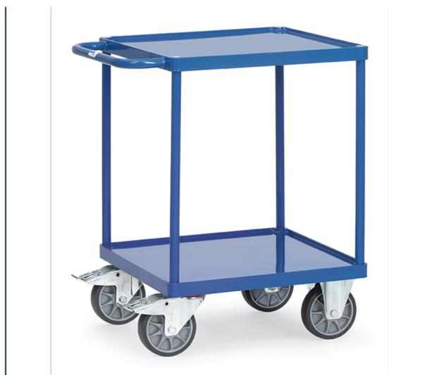
Système modulaire: ensemble mécano-soudé, revêtement époxy RAL 5007, assemblé selon le principe des "inserts fetra". Plateau en tôle d'acier soudé avec rebord de 10 mm de haut. 2 roues pivotantes et 2 fixes à bandage TPE, moyeu à roulement à billes central. Freins sur roues pivotantes. Charge maximum plateau du haut: 200 kg.
