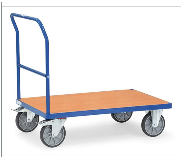
Système modulaire. Ensemble mécano-soudé, revêtement époxy bleu RAL 5007, plateau en mélaminé surface effet hêtre. 2 roues pivotantes et 2 roues fixes à bandage TPE, moyeu à roulement à billes central. Freins sur roues pivotantes.
