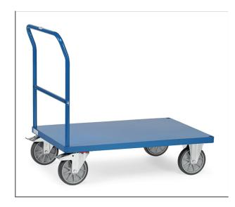
Système modulable. Ensemble mécano-soudé, revêtement époxy bleu RAL 5007, plateau en tôle d'acier soudé de niveau dans l'armature. 2 roues pivotantes et 2 roues fixes à bandage TPE, moyeu à roulement à billes central. Freins sur roues pivotantes.
