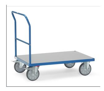
Système modulable. Ensemble mécano-soudé, revêtement époxy bleu RAL 5007. Dimensions utiles 1200 x 800 mm. Plateau en PVC dur gris foncé, résistant aux intempéries et à la plupart des produits corrosifs. 2 roues pivotantes et 2 roues fixes à bandage TPE, moyeu à roulement à billes central. Freins sur roues pivotantes.
