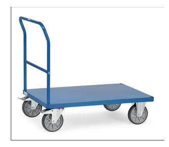
Système modulable. Ensemble mécano-soudé, revêtement époxy bleu RAL 5007, plateau en tôle d'acier soudé de niveau dans l'armature. 2 roues pivotantes et 2 roues fixes à bandage TPE, moyeu à roulement à billes central. Freins sur roues pivotantes.
