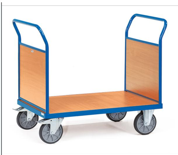
Ensemble mécano-soudé, revêtement époxy bleu RAL 5007, plateau en mélaminé surface effet hêtre avec 2 ridelles en mélaminé, hauteur 500 mm. 2 roues pivotantes et 2 roues fixes à bandage TPE, moyeu à roulement à billes central. Freins sur roues pivotantes.
