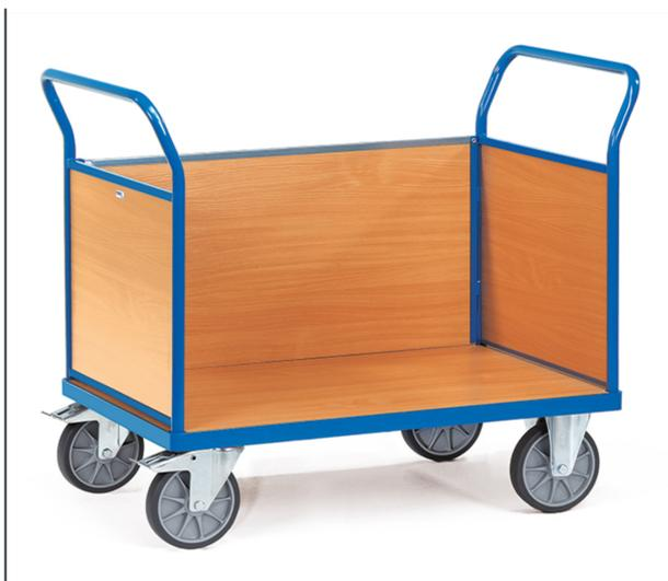
Ensemble mécano-soudé, revêtement époxy bleu RAL 5007, plateau en mélaminé surface effet hêtre avec 3 ridelles en mélaminé, hauteur petits et grand côtés 500 mm, grand côté boulonné. 2 roues pivotantes et 2 roues fixes à bandage TPE, moyeu à roulement à billes central. Freins sur roues pivotantes.
