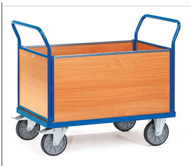
Ensemble mécano-soudé, revêtement époxy bleu RAL 5007, plateau en mélaminé surface effet hêtre avec 4 ridelles en mélaminé, hauteur petits et grands côtés 500 mm, 2 grands côtés amovibles dont un boulonné. 2 roues pivotantes et 2 roues fixes à bandage TPE, moyeu à roulement à billes central. Freins sur roues pivotantes.
