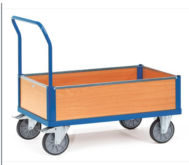
Ensemble mécano-soudé, revêtement époxy bleu RAL 5007, plateau et ridelles en bois, hauteur 250 mm. 2 roues pivotantes et 2 roues fixes à bandage TPE, moyeu à roulement à billes central. Freins sur roues pivotantes.
