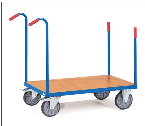
Système modulaire. Ensemble mécano-soudé, revêtement époxy bleu RAL 5007, plateau en mélaminé surface effet hêtre. Longueur des barres 640 mm. 2 roues pivotantes et 2 roues fixes à bandage TPE, moyeu à roulement à billes central. Freins sur roues pivotantes.
