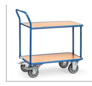
Ensemble mécano-soudé en tube d'acier, revêtement époxy bleu RAL 5007 uniquement. Plateforme en mélaminé surface effet hêtre. Plateau du haut amovible. 2 roues pivotantes et 2 roues fixes à bandage TPE, moyeu à roulement à billes central. Freins sur roues pivotantes. Charge plateau du haut 120 kg.
