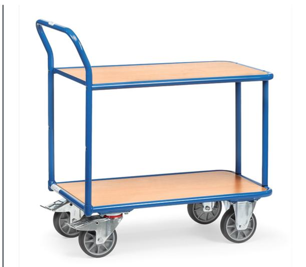
Ensemble mécano-soudé en tube d'acier, revêtement époxy bleu RAL 5007 uniquement. Plateforme en mélaminé surface effet hêtre. Plateau du haut amovible. 2 roues pivotantes et 2 roues fixes à bandage TPE, moyeu à roulement à billes central. Freins sur roues pivotantes. Charge plateau du haut 120 kg.
