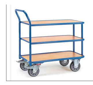
Ensemble mécano-soudé en tube d'acier, revêtement époxy bleu RAL 5007 uniquement. Plateforme en mélaminé surface effet hêtre. Plateaux du haut et milieu amovibles. 2 roues pivotantes et 2 roues fixes à bandage TPE, moyeu à roulement à billes central. Freins sur roues pivotantes. Charge plateau du haut et milieu 120 kg.
