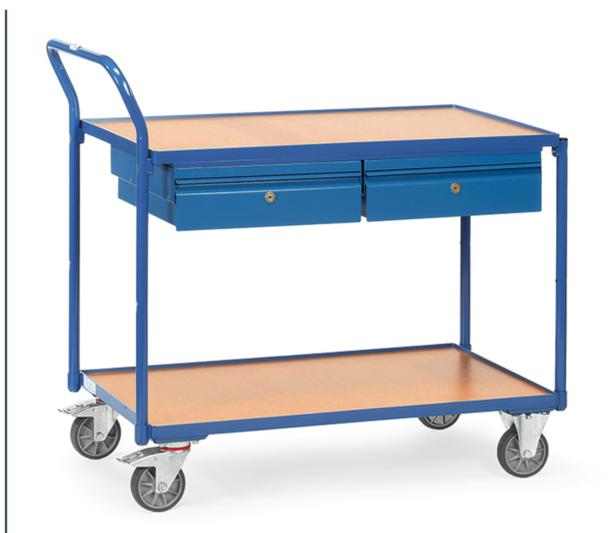
Ensemble mécano-soudé, revêtement époxy bleu RAL 5007 avec un plateau en mélaminé surface effet hêtre, barre de poussée verticale, rebord de 12 mm. Charge maximum étagère haute: 80 kg. 2 tiroirs en tôle d'acier (HXLXP: 105 x 415 x 490 mm), charge maximum tiroir: 25 kg. 2 roues pivotantes et 2 roues fixes à bandage TPE, moyeu à roulement à billes central. Freins sur roues pivotantes.
