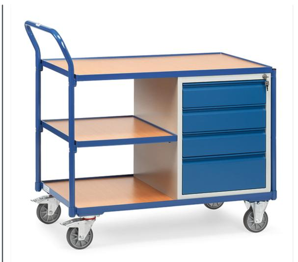
Ensemble mécano-soudé, revêtement époxy, caisson gris RAL 7035, armature et tiroirs RAL 5007. Plateaux en bois avec rebord de 12 mm de haut. 1 placard roulant avec serrure centrale (HXLXP: 600 x 500 x 600 mm) et 4 tiroirs (3 x 120 mm de haut et 1 x 180 mm de haut). Ouverture au 4/5. Charge par tiroir: 25 kg. 2 roues pivotantes et 2 roues fixes à bandage TPE, moyeu à roulement à billes central. Freins sur roues pivotantes.
