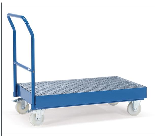
Construction en tôle d'acier soudée, revêtement époxy bleu RAL 5007. Bac étanche de 100 mm de haut. Caillebotis à niveau, grille de 31 x 31 mm, zinguée. Pour le déplacement de 1 à 2 fûts de 200 litres. Évite les dégâts causés par la fuite de produits toxiques. Contenance de la cuve 45/54 litres. 2 roues fixes et 2 roues pivotantes en polyamide Ø 125 x 38 mm, moyeu à roulement à rouleaux. Freins sur roues pivotantes.
