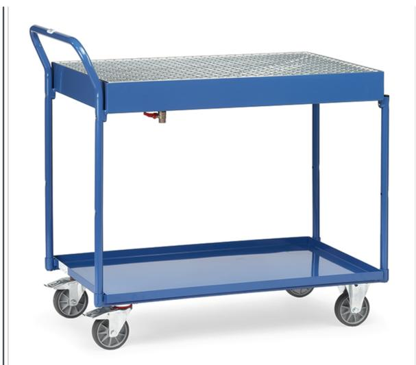
Construction en acier avec 1 plateau étanche rebord de 25 mm et 1 plateau avec bac étanche de 100 mm de haut. Fond incliné pour l'écoulement et robinet de 1/2", grille à maillons de 31 x 31 mm, dossier de poussée vertical. 2 roues pivotantes et 2 roues fixes à bandage TPE, moyeu à roulement à billes central. Freins sur roues pivotantes.
