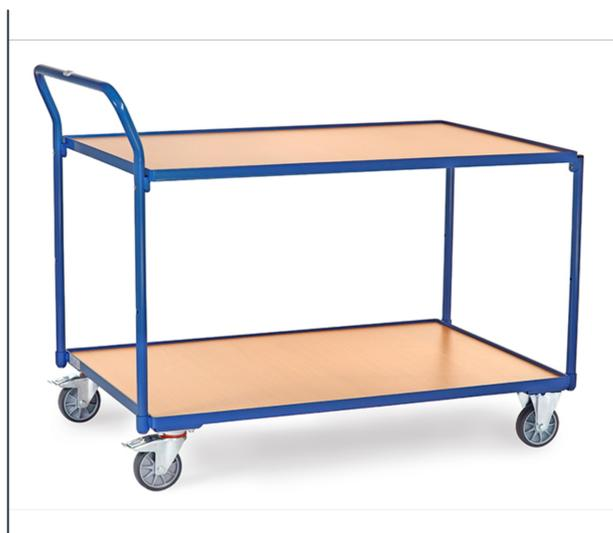
Ensemble mécano-soudé, revêtement époxy bleu RAL 5007 avec 2 plateaux en mélaminé surface effet hêtre, barre de poussée verticale, rebord de 12 mm. Charge maximum étagère haute: 80 kg. 2 roues pivotantes et 2 roues fixes à bandage TPE, moyeu à roulement à billes central. Freins sur roues pivotantes.
